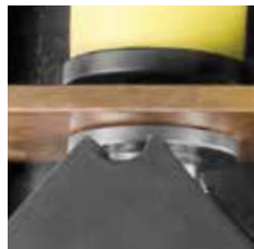
Пробивка отверстий SH 403, SH 404, SH 409.
