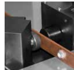
Вдавливание гаек SH 407.
