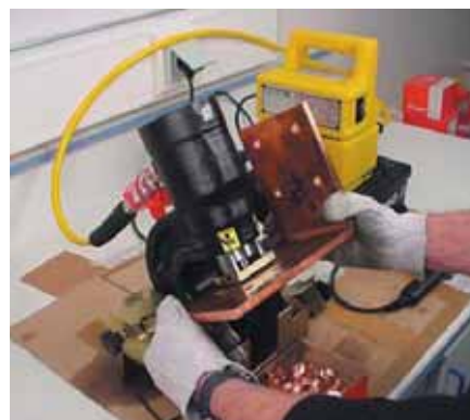
Гидравлический перфоратор точно пробивает отверстия без образования стружки и без усилий
