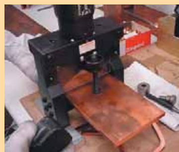
Гибка медной шины толщиной 10 мм на гидравлическом портативном оборудовании
